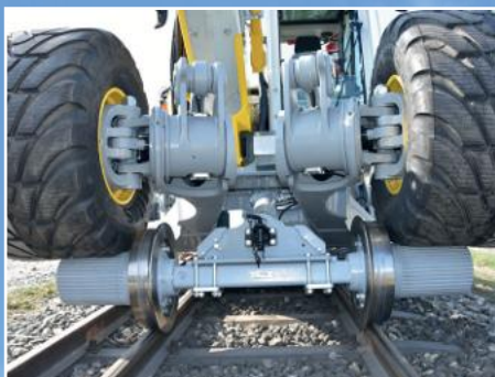
Maximale Flexibilität mit einem Fahrwerk für drei Spurbreiten: 1668 mm, 1435 mm, 1000 mm, 760 mm.
