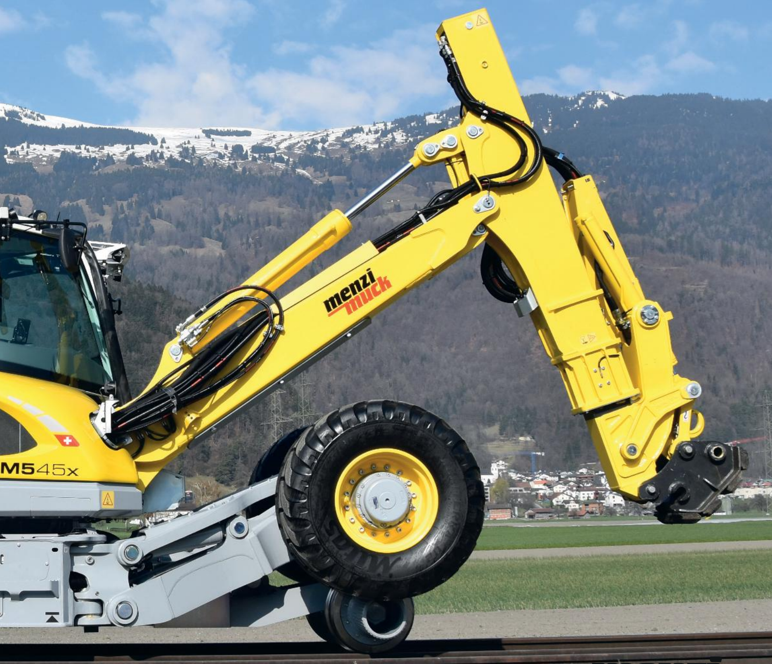
Maximale Flexibilität mit einem Fahrwerk für drei Spurbreiten: 1668 mm, 1435 mm, 1000 mm, 760 mm.
