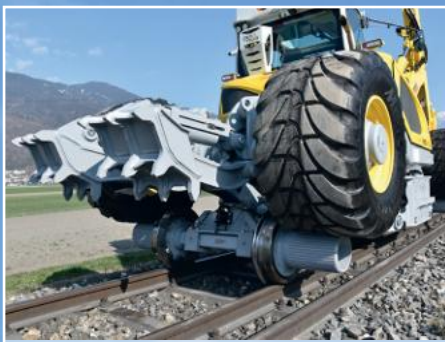
Maximale Traction dank stufenlosem hydrostatischem Fahrtrieb über die Reibtrommeln auf die Schienen.
