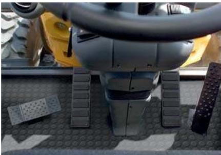
Schwenken mittels Fußpedal für ermüdungsfreies Arbeiten
