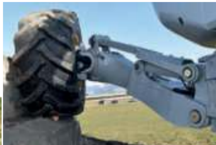
Intelligente Anordnung der Drehpunkte
